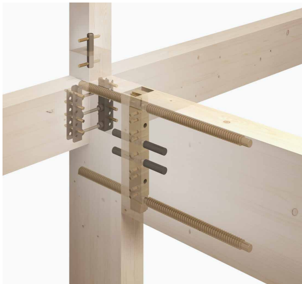
Node.Rigid柱梁接合部(コネクタタイプ): ラグスクリーボルトを使用し高強度、高剛性接合部を実現し、様々なラーメンフレームを構成可能
