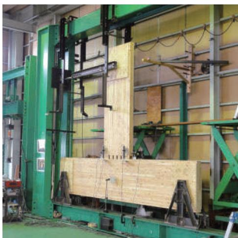
ストローグ保有の1000kN(100t)水平加力試験機。
